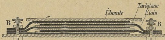
Fig. 20. — Montage d'un condensateur fixe à tarlatane et feuilles d'étain. B, B, bornes de prises.
