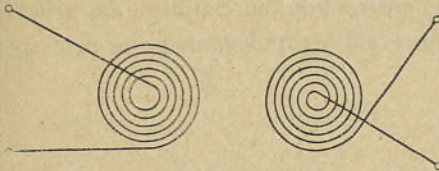
Fig. 109. — Sens de bobinage des fonds de panier de l'hétérodyne.
