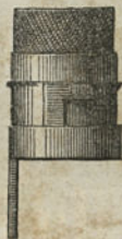
Fig. 7. — Assemblage à baïonnette de l'anneau mobile qui porte une mèche sur l'anneau fixe soudé à la tige de la crémaillère.
