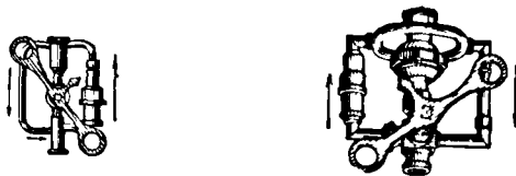
FIG. 185. — Pose des rhéomètres sur les conduites descendantes.
