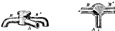
Fig. 88. — Robinet pour la préparation directe de l'acide azotique blanc.
