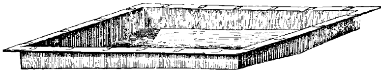
Fig. 84. — Bassin pour la cristallisation du salpêtre.
