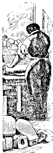
Fig. 200. — Moulage à la croûte; préparation de la croûte au rouleau.
