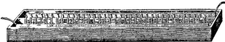
qu'un petit nombre. Deux longues lames de plomb y amènent le courant de quatre éléments de Bunsen ou de six éléments de Daniell. La force électromotrice nécessaire pour charger ce système doit être, en effet, double de celle qui suffit pour charger un seul couple secondaire.
