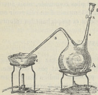
Fig. 84. — Appareil de Pasteur pour la culture des anaérobies.
