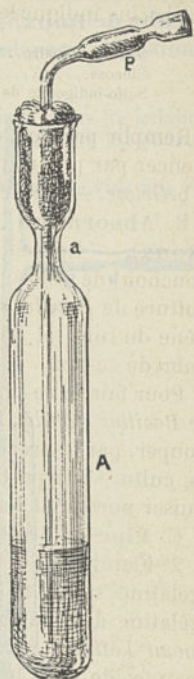
Fig. 94. — Dispositif de Roux pour la culture des anaérobies en gélatine.
