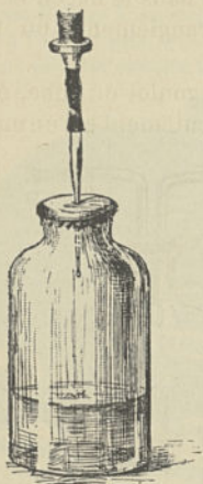
Fig. 14. — Dispositif pour recueillir le liquide filtré au sortir de la bougie.
