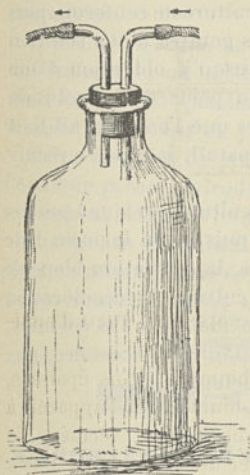
Fig. 82. — Flacon de sûreté pour la trompe à eau.
