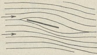
FIG. 45. — Ecoulement de l'air aux faibles incidences.
