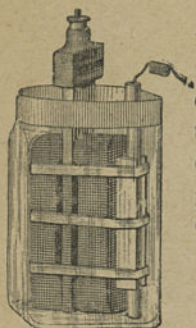
Fig. 2 Pile Leclanché, à plaques agglomérées
