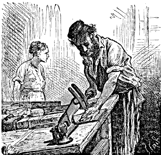
Fabrication des allumettes. — Débitage du bois (p. 417).
