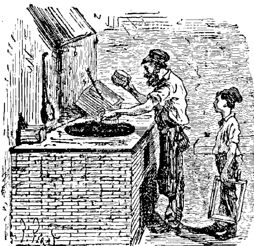
Soufrage des allumettes à la main (p. 447).
