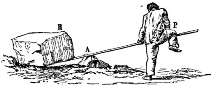
*Fig.* 236. — A, point d'appui ; R, résistance ; P, puissance.
