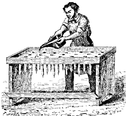
Fig. 46. — Moulage des chandelles.
