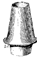
Fig. 172. — Rétrécissement de l'extrémité du tuyau d'une cheminée.
