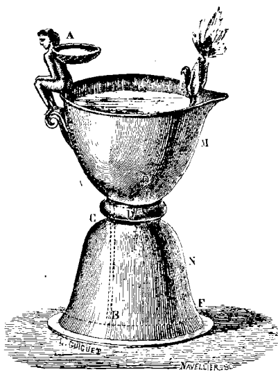
Fig. 27. — Lampe hydraulique de Héron.
