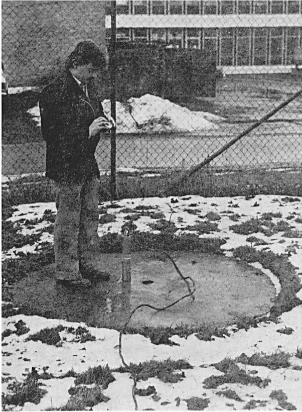
Photo 1. — Détecteur sur les dalles de calibrage de la Faculté Polytechnique de Mons.
