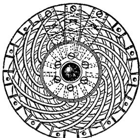
Fig. 245. — Connexions entre la bobine et le collecteur de la machine Siemens « C ».
