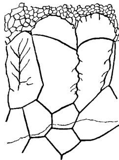
FIG. 4. — Réseau et joints de grains formés sur une lame partiellement fondue et solidifiée (la ligne fine et dentelée représente, à la partie inférieure, la limite atteinte par la fusion).
