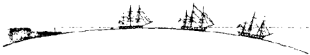
Fig. 228. — Positions successives d'un navire par rapport à l'horizon de la côte du départ.
