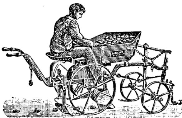
un à un dans les godets du système distributeur par un enfant assis sur un siège disposé sur le bâti.
