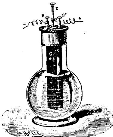
FIG. 17. — Pile-bouteille de Grenet.
