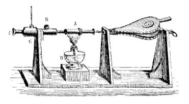
A, fourneau. — C'est un tube de cuivre, contenant dans son intérieur quinze toiles métalliques, disposées verticalement les unes près des autres, et qui ont pour effet, en accumulant le calorique dans cette partie de l'appareil, de maintenir la température des vapeurs de chloroforme à peu près au même point pendant toute la durée de leur administration.
