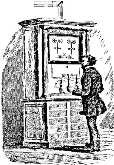
Fig. 191. Télégraphe électrique anglais ou appareil à aiguilles.
