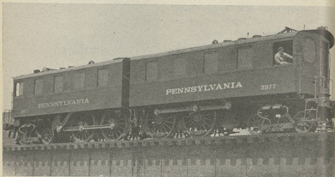
FIG. 26. — Locomotive Westinghouse à courant continu : Pennsylvania R 4 .
