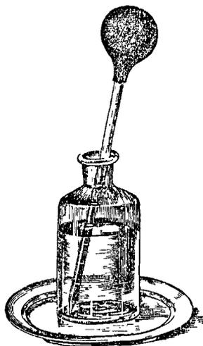
Fig. 100. — Flaçon à acide sulfurique avec pipette à boule en caoutchouc.
