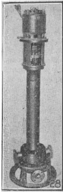
Fig. 129. Pompe à acide Lewis.
