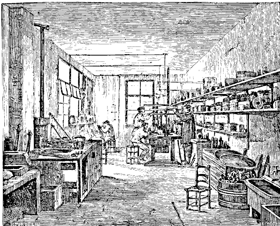
Fig. 174. — Préparation des moules destinés à la galvanoplastie (pétrissage et moulage à la presse).
