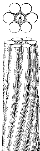
Fig. 111. — Câble sous-marin entre l'Angleterre et l'Irlande (partie côtière du câble, — grandeur naturelle).
