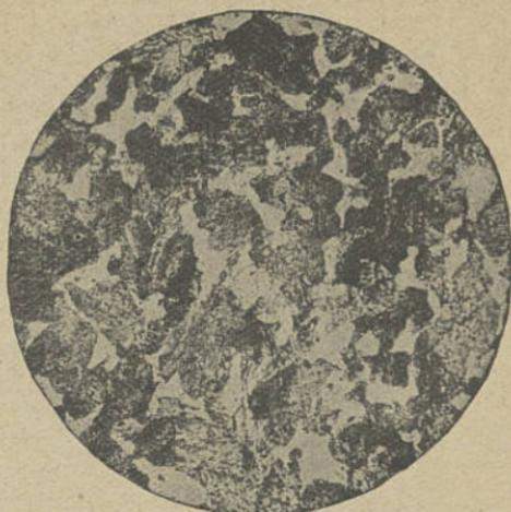
Fig. 9. — Acier à 0,54 pour 100 de C, recuit à 850°, ferrite claire, perlite foncée, attaque au réactif de Bénédicts. (Grossissement 200 D.)
