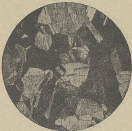
Fig. 20. — Cuivre recuit à 900°, attaque au perchlorure de fer.
