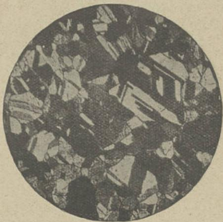
Fig. 19. — Cuivre recuit à 800°, attaque au perchlorure de fer.
