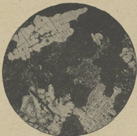
Fig. 15. — Cuivre fondu, attaque au perchlorure de fer,
