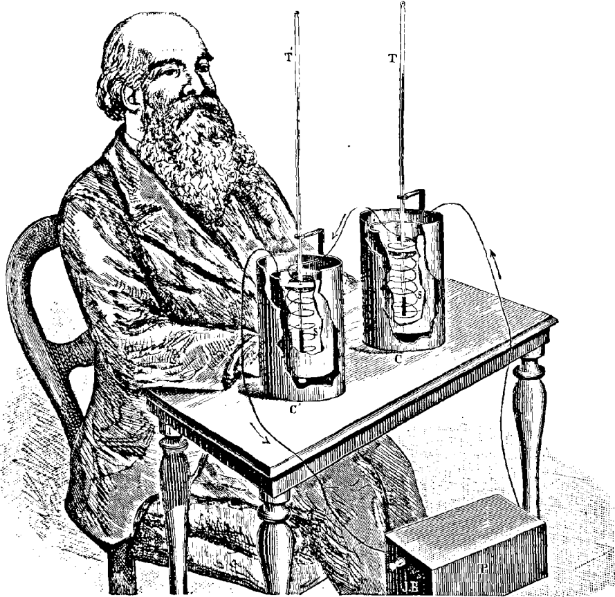
Fig. 271. — Joule mesurant l'échauffement des fils métalliques par le passage d'un courant électrique.
