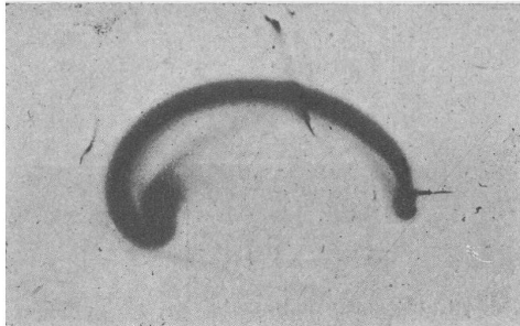
FIG. 9. — Enroulement de la lumière positive dans un champ de 500 unités. Distance des électrodes, 5 centimètres (décharge condensée sans gaine négative). La fig. 8 indique le montage de l'expérience.
