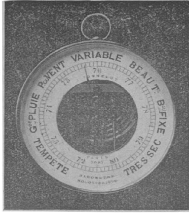
Dans ce type de baromètre anéroïde, un système de leviers transforme en mouvement circulaire les déformations d'une boîte de Vidie. Modèle Tonnelot.
