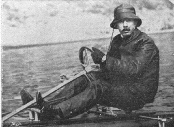
L'HYDROPLANE de Santos-Dumont, avec lequel celui-ci espère faire 100 kilomètres à l'heure, a été expérimenté le 17 octobre, sans grand succès. Il se compose de deux plans glisseurs et est mû par une hélice aérienne, actionnée par un moteur de 50 chx.
