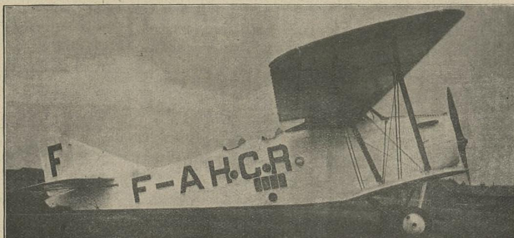
AVION SECM DE BOMBARDEMENT DE NUIT, TYPE 12, MOTEUR 600 CV
