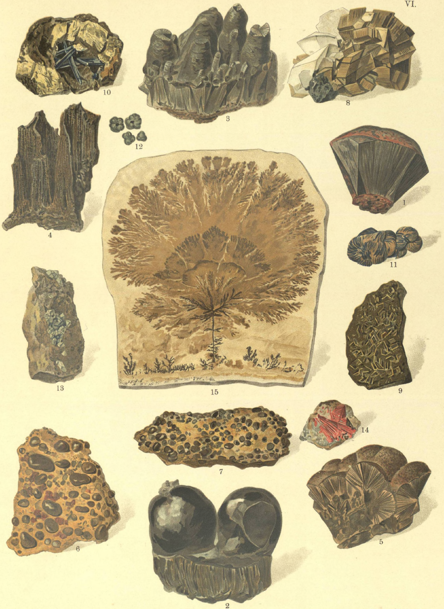
1. Hématite rouge. Sesquioxyde de fer anhydre fibreux. 2. Hématite brune. Sesquioxyde de fer hydraté fibreux. 3. Hématite brune concrétionnée. 4. Hématite brune stalactiforme. 5. Goéthite. Sesquioxyde de fer hydraté fibreux. 6 et 7. Limonite. Sesquioxyde de fer hydraté pisolithique. 8. Sidérose. Carbonate de fer cristallisé. 9. Pyrrhotine. Sulfure de fer hexagonal. 10. Vivianite. Phosphate ferreux hydraté bleu cristallisé. 11. Vivianite. Cristaux groupés. 12. Vivianite réniforme. 13. Scorodite. Arséniate ferreux hydraté bleu cristallisé. 14. Erythrine. Arséniate de cobalt hydraté rose cristallisé. 15. Dendrites de fer (jaunes) et de manganèse (noires).
