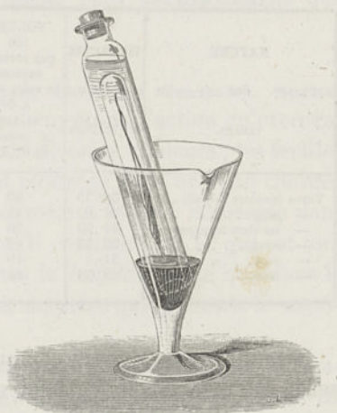
FIG. 5. — Éprouvette à double enveloppe, employée par M. Cailletet pour déterminer l'influence de divers rayons lumineux sur la décomposition de l'acide carbonique. On introduit par l'orifice supérieur le liquide coloré.
