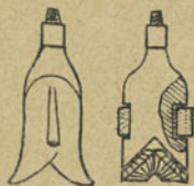
Fig. 9. — TRÉPANS POUR ROTARY (en queue de poisson).
