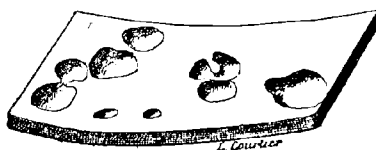
Fig. 717. — Corrosion par pustules.
