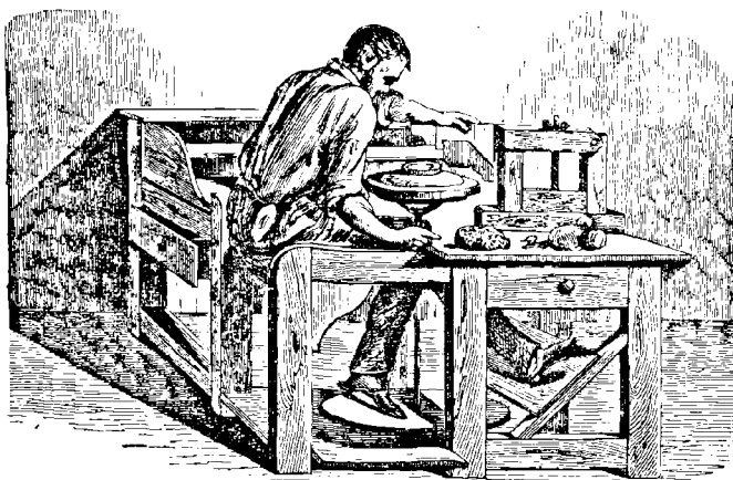
Fig. 90. Façonnage d'une assiette sur le tour à potier, avec le gabarit .
