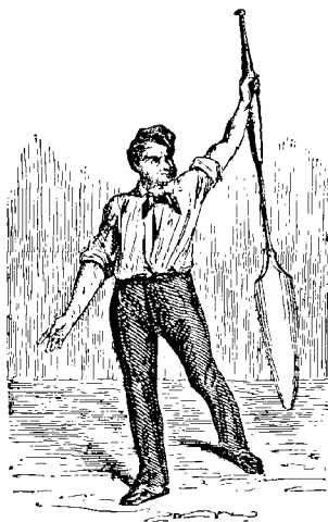
Fig. 58. Fabrication d'un carreau de verre. (Production du manchon.)
