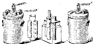
Pile impolarisable de Cloris Baudet.
