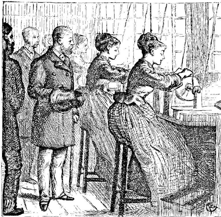
FABRICATION DES PLUMES D'ACIER. — L'aiguisage. (Page 1191, col. 3.)
