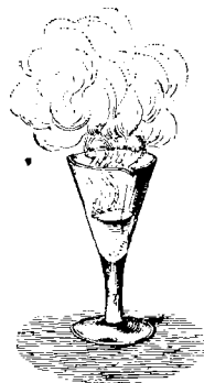
Fig. 57. — Production de l'acide hypoazotique.
