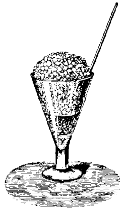
Fig. 146. Décomposition d'un carbonate par un acide.
