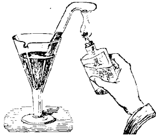
Fig. 28. — Analyse de l'air par le phosphore à chaud.
