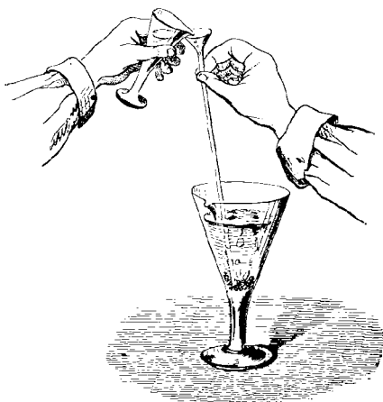
Fig. 171. — Combustion du phosphore sous l'eau au moyen du chlorate de potasse.
