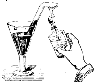
Fig. 48. — Analyse de l'air par le phosphore.
