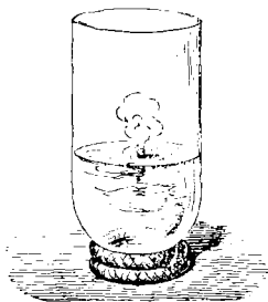
Fig. 84. — Action du potassium sur l'eau.
