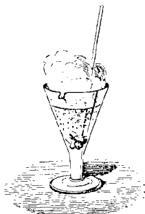
Fig. 35. Réaction de l'étain sur l'acide azotique.
