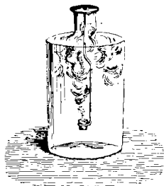
Fig. 64. Combustion du phosphore dans le chlore.
