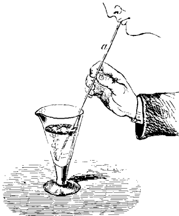
Fig. 41. — Air chassé des poumons à travers l'eau de chaux.
