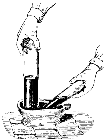
Fig. 25. — Mélange de deux gaz sur la cuve à mercure.
