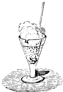
Fig. 157. — Vapeurs rutilantes produites par un mélange d'azotate et de limaille de cuivre humecté d'acide sulfurique.
