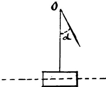
mobile autour d'un axe fixe et rempli d'une matière plastique qui arrête le projectile pendant un temps assez court pour que le déplacement du récepteur soit insensible, mais au bout duquel ce récepteur prend une vitesse angulaire sensible de sorte qu'il exécute une série d'oscillations dont on mesure l'amplitude maximum.
