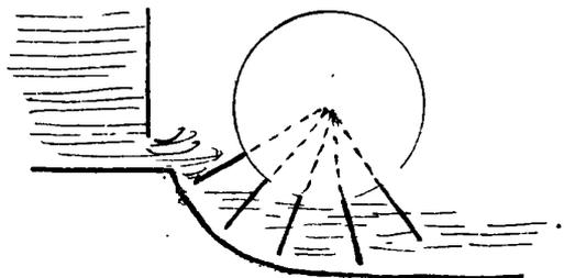
Soient  $V$  la vitesse de l'eau à son arrivée,  $v$  sa vitesse à la sortie, que l'on supposera égale à celle des palettes de la roue; il est clair que c'est la différence de ces vitesses qui oblige la roue à tourner. Ainsi la roue de côté ne satisfait pas aux conditions que doit remplir un moteur hydraulique parfait: 1<sup>o</sup> parce qu'il y a un choc de l'eau contre les palettes, 2<sup>o</sup> parce que le liquide sort de la roue avec une vitesse sensible.
