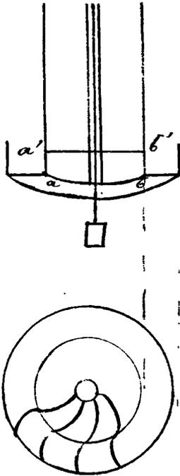
Le fond est supporté par un tuyau dit porte-fond. Le cylindre est divisé à sa partie inférieure par des aubes qui dirigent le liquide dans son écoulement latéral. Autour de la partie enlevée se trouve une couronne munie d'aubes courbes mais dirigées en sens inverse de celles du cylindre. Cette couronne peut tourner autour d'un axe vertical.
