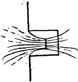
L'air compris entre la veine et la paroi de l'ajutage est rapidement entraîné, la pression diminue dans le voisinage de la section contractée et, d'après le théorème de Bernoulli, la vitesse de sortie augmente. D'autre part, la pression extérieure étant égale à celle de
