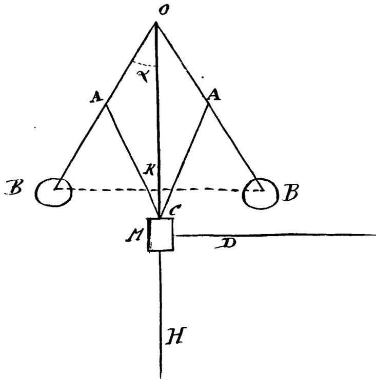
Le régulateur de Watt est constitué par un arbre vertical  $OH$  auquel l'arbre de la machine communique un mouvement de rotation, par deux tiges  $OB$  articulées en  $O$  et terminées par deux sphères pesantes, par deux tiges  $AC$  articulées en  $A$  avec les précédentes et en  $C$  avec un manchon  $M$  qui peut glisser sans frottement sur l'arbre vertical. Le manchon est relié à un levier  $MD$  de sorte que le déplacement du manchon entraîne celui du levier.
