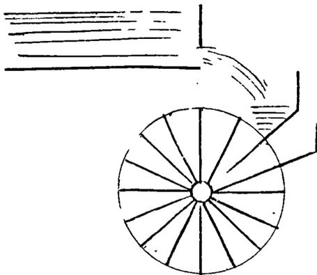
d'une jante cylindrique reliée à l'arbre par une série de rayons. Sur le pourtour sont disposés des augets, espaces égaux compris entre des aubes ou chevrons et limités latéralement par
