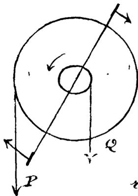
Soient P la puissance et Q la résultante. — Sur l'arbre sont disposées des palettes planes dont les plans passent par l'axe et qui sont deux à deux symétriques par rapport à cet axe.
