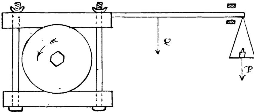
On cale sur cet arbre une poulie et sur cette poulie, l'on place deux pièces évidées formant colliers. Ces deux pièces sont réunies par des boulons que l'on peut serrer plus ou moins au moyen d'écrous. Un levier fixé entre les deux pièces est maintenu entre deux arrêts.
