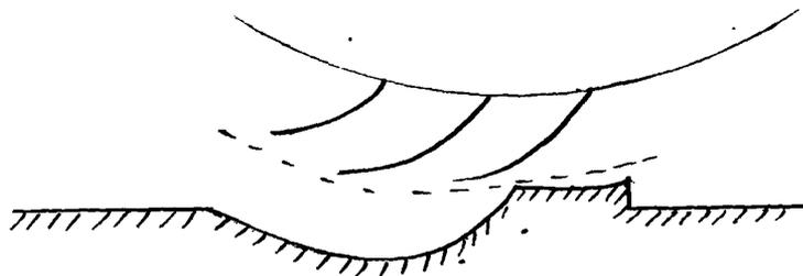
Il se compose d'une droite, d'une courbe dont la forme sera indiquée ultérieurement d'un cercle suivi d'une portion de verticale, enfin d'une horizontale. Le profil des aubes est courbe.
