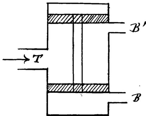
La vapeur arrive par le tuyau  $T$ . La boîte à vapeur communique avec la partie inférieure et avec la partie supérieure du corps de pompe par les orifices  $B$  et  $B'$ . Le tiroir formé par deux pistons solitaires est mobile dans la boîte à vapeur.
