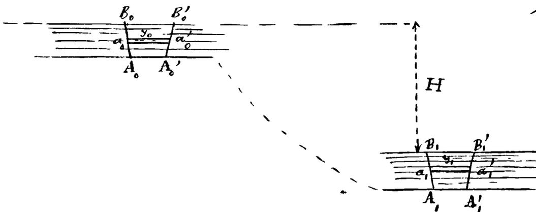
Le canal supérieur s'appelle le bief d'amont, le canal inférieur le bief d'aval. La différence de niveau des deux biefs est la hauteur de chute ou plus simplement la chûte.
