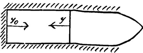
En appelant  $C_0$  la section droite de l'âme et en désignant par  $y_0$  et  $y$  les pressions par unité de surface respectivement exercées par les gaz sur la culasse et sur le projectile, les seules forces extérieures qui agissent sur le système parallèlement à la direction
