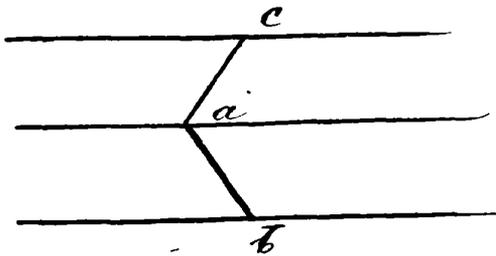
L'eau est encore guidée dans le cylindre fixe et dans le cylindre mobile par des aubes; mais ici les aubes sont superposées. La figure ci-jointe qui suppose le cylindre développé, montre la disposition des aubes; ac est l'aube fixe et ab l'aube mobile.
