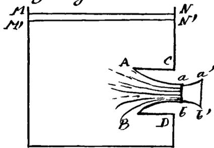
un tube cylindrique rentrant ABCD. Il est nécessaire, que la longueur du tube n'excede pas son diamètre pour que la veine ne mouille pas sa paroi.
