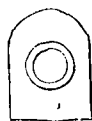
Fig. 82. — Plaque avec ajutage pour la fermeture de la moitié supérieure de l'ouverture du moufle ; vue antérieure.
