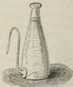
muni d'une tubulure latérale, placée immédiatement au-dessus du fond, mais qui ne monte pas aussi haut que son col. L'huile et l'eau se rassemblent dans le récipient, l'huile surnage et gagne ainsi la partie étroite de l'appareil, tandis que l'eau occupe la partie la plus large. Dès que l'huile se trouve au niveau de la branche supérieure du tube recourbé, l'eau s'écoule, à mesure qu'elle arrive, par le bec de ce tube. De cette façon, l'huile se
