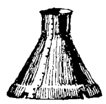
Cheminée pour envelopper le creuset.
