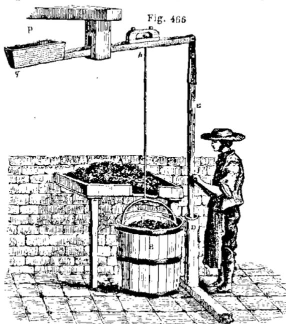
fond est formé par une toile métallique assez fine pour que les fragments de minerai ne puissent pas passer à travers les mailles. Ce tamis est attaché à une tige verticale en fer *h*, fixée à articulation sur un levier horizontal *qh*, équilibré par un contre-poids *P*. Le tamis est maintenu dans un baquet *B* rempli d'eau. L'ouvrier le manœuvre à l'aide d'une tige de bois
