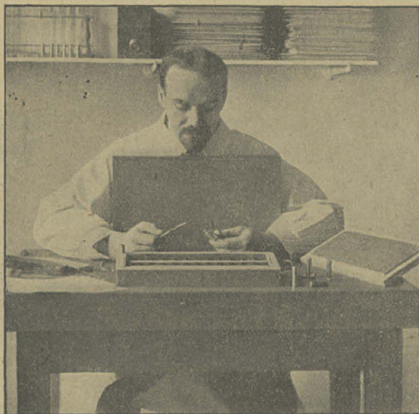
Introduction d'une ampoule de radium dans un tube de transport en plomb.
