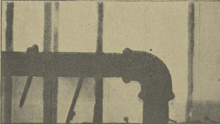
Les rayons X permettent de découvrir dans les murs des pièces de fer qu'il est parfois nécessaire de faire disparaître. (Cour-circuit, etc.)
