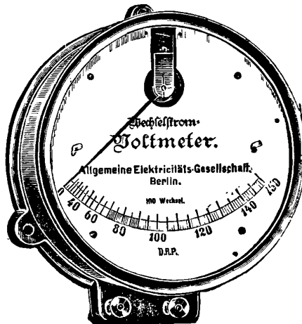
FIG. 19. — Voltmètre à induction.
