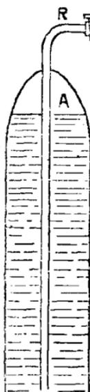
ouvrant le robinet R, par suite de la pression qui règne en A (et nous savons qu'en vertu du choix du gaz, cette pression est supérieure à 1 atmosphère), le gaz jaillit par le tube d'échappement, d'une longueur de 3 ou 4 m., attaché à la bonbonne.
