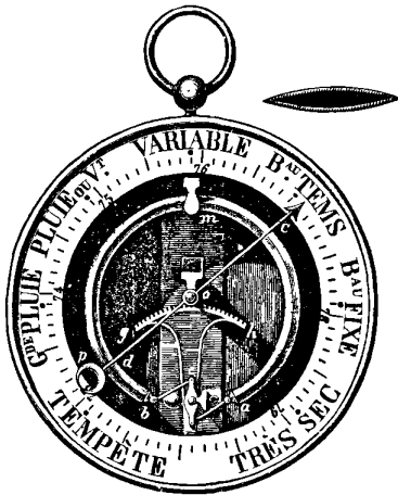
Fig. 66. Baromètre de M. Bourdon.
