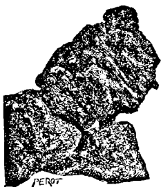
Fig. 101. — Imitation artificielle de la météorite de Sainte-Catherine : fragments de fonte traités par l'hydrogène sulfuré et cimentés ainsi par de la pyrrhotine. Grandeur naturelle.
