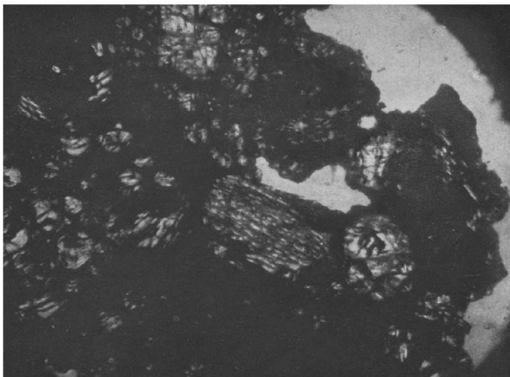
Fig. 104. — Montréjite chauffée une heure au rouge et transformée ainsi en stawropolite. Lamelle mince vue au microscope.
