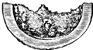
Fig. 95. — Production artificielle, par voie de concrétion, des granules]de fer nickelés des sporadosidères. Grandeur naturelle.
