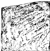
Fig. 7. — Figure incomplète produite sur un fer météorique par le bichlorure de mercure en solution froide (caillite de Charcas). Grandeur naturelle.
