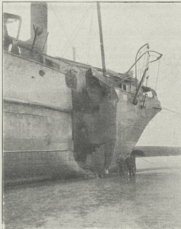
Une fameuse brèche dans la coque d'un cargo
