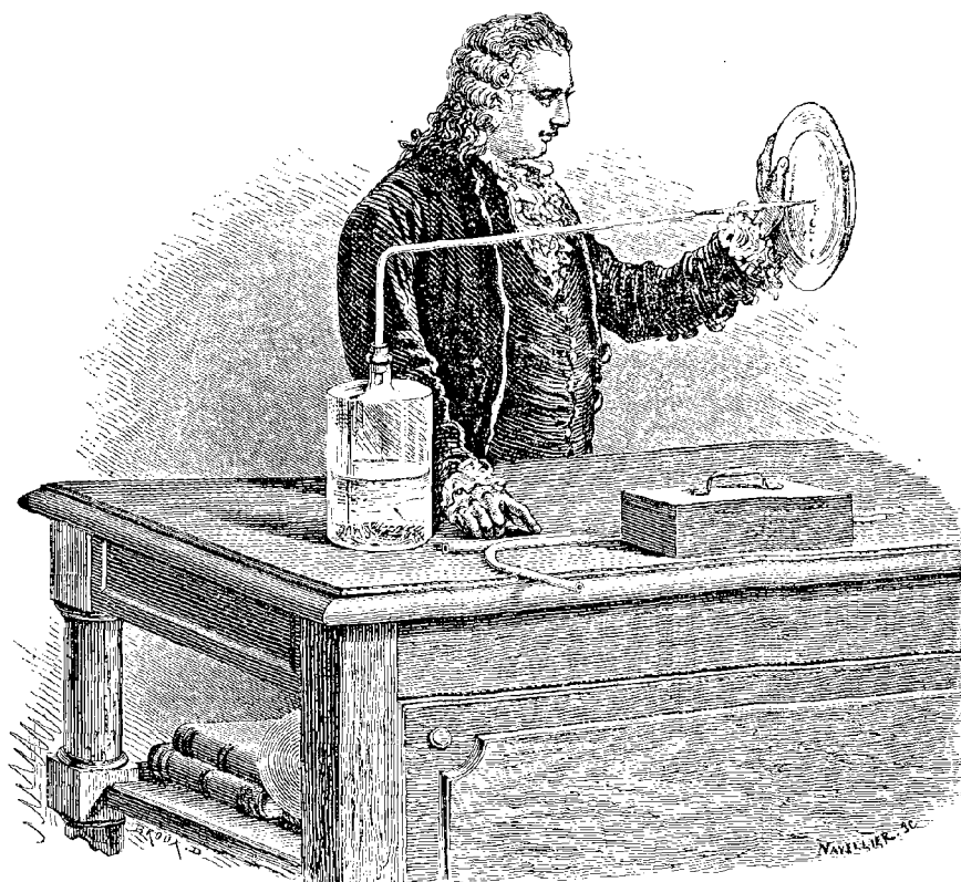
Fig. 3. — Expérience de Macquer. Combustion du gaz hydrogène à l'air, contre une soucoupe de porcelaine.
