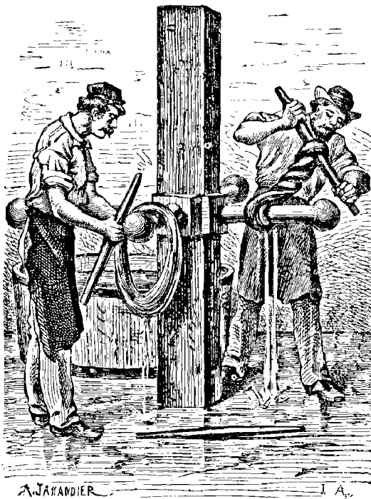
Fig. 213. — Espart ou appareil à tordre les écheveaux.
