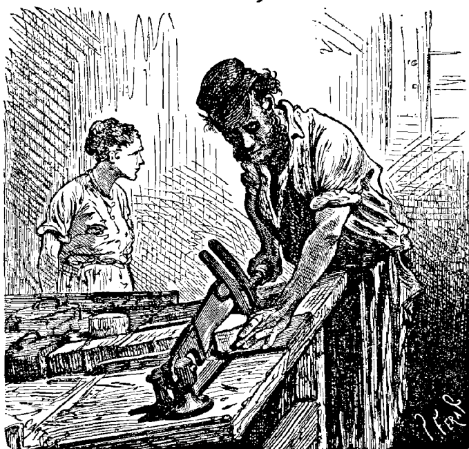
Fig. 244. — Débitage du bois à la main pour la fabrication des allumettes.
