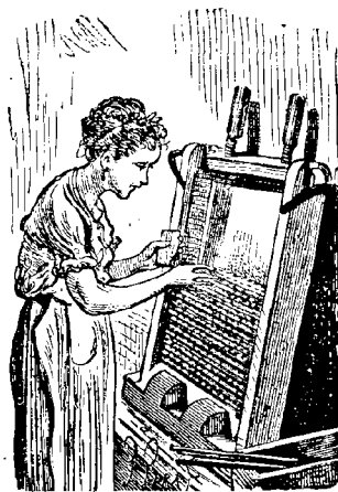
Fig. 251. — Mise en presse à la main des allumettes chimiques.
