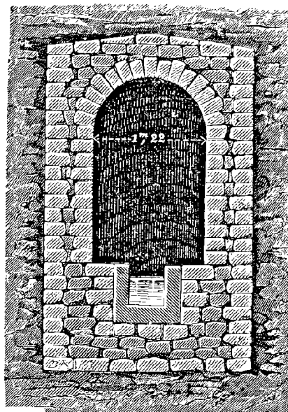
Fig. 107. — Coupe de l'aqueduc de Montpellier.
