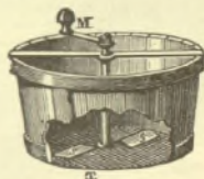
Fig. 142. — Tamis servant à l'extraction de l'amidon par fermentation.
