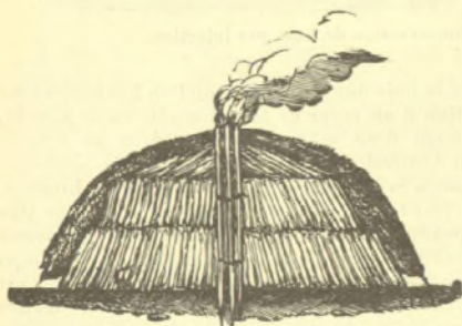
Fig. 57. — Préparation du charbon de bois par le procédé des meules.
