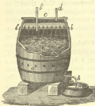
Fig. 179. — Appareil pour la fabrication du vinaigre, procédé allemand.
