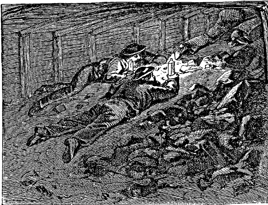
Exploitation par éboulements.
