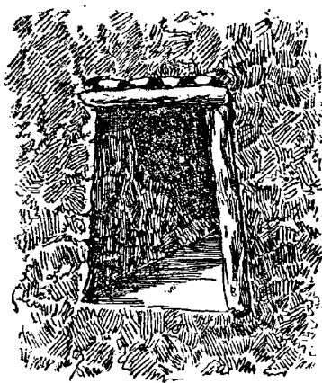
Boisage partiel d'une galerie.
