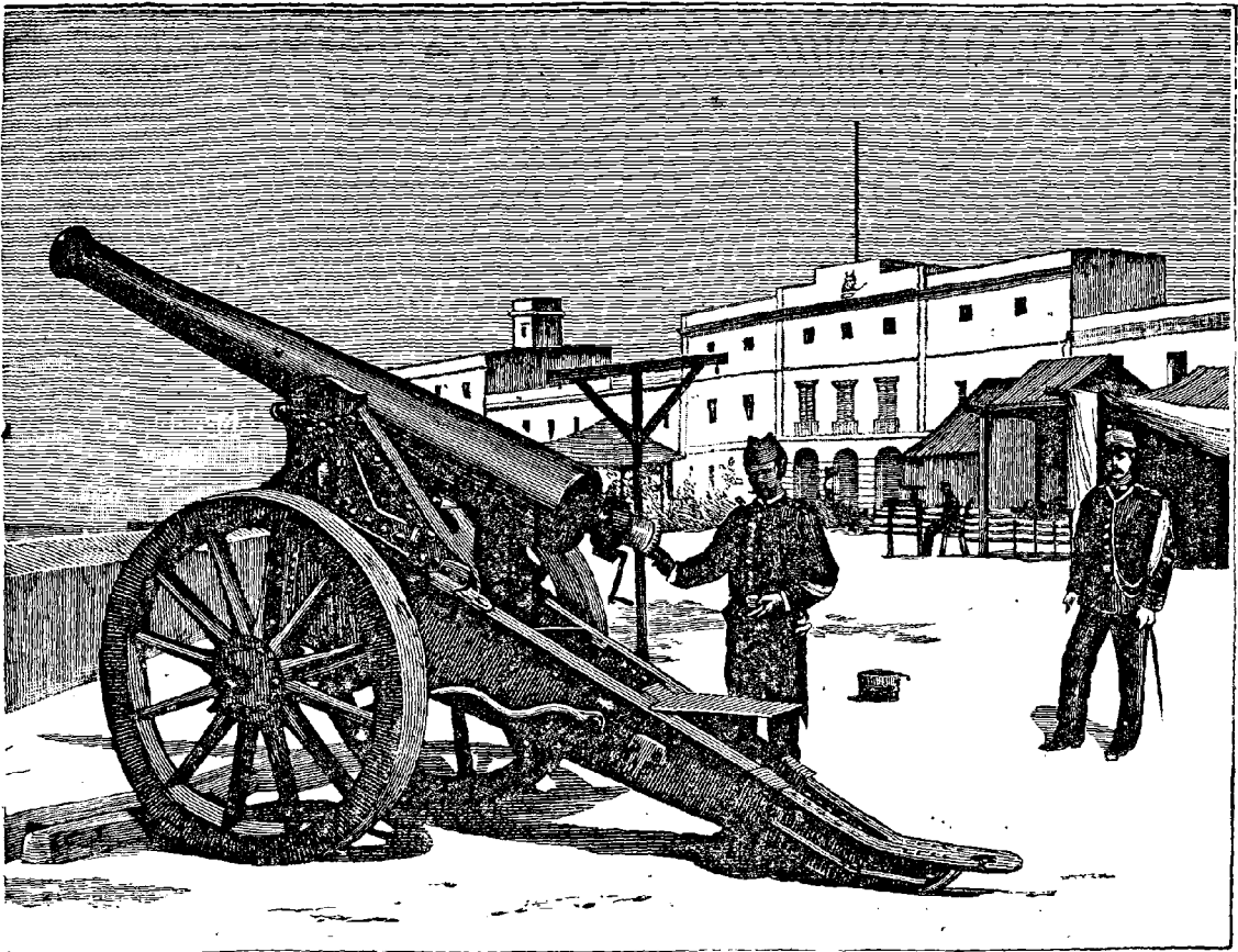
Canon espagnol (système Plasencia), pièce de 12 centimètres.
