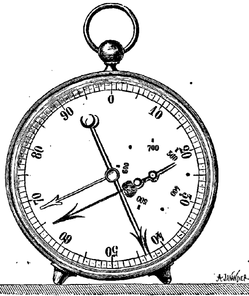
Baromètre métallique compensé, pour les hauteurs de 6,000 mètres.
