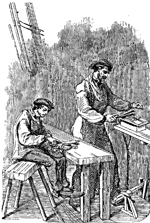
Séparation des aiguilles jumelles.
